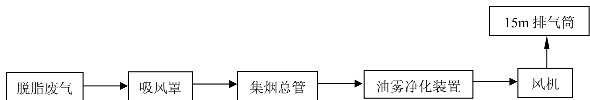
图 7-2 脱脂废气收集处理流程图
